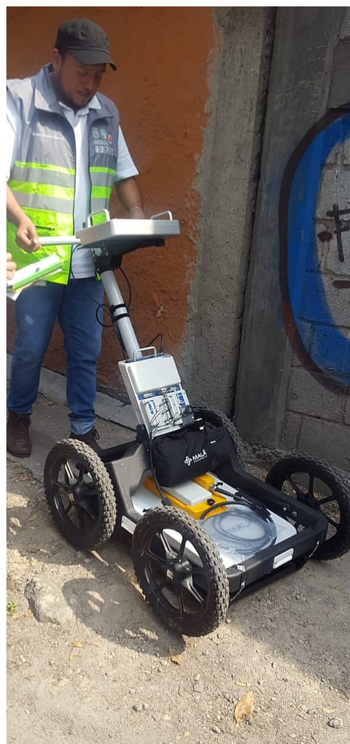
Levantamiento de imágenes con Radar de Penetración Terrestre, actividad que nos ayudará a estructurar la base de datos para la creación del módulo de administración de contenidos de levantamientos en campo, SGIRPC.
