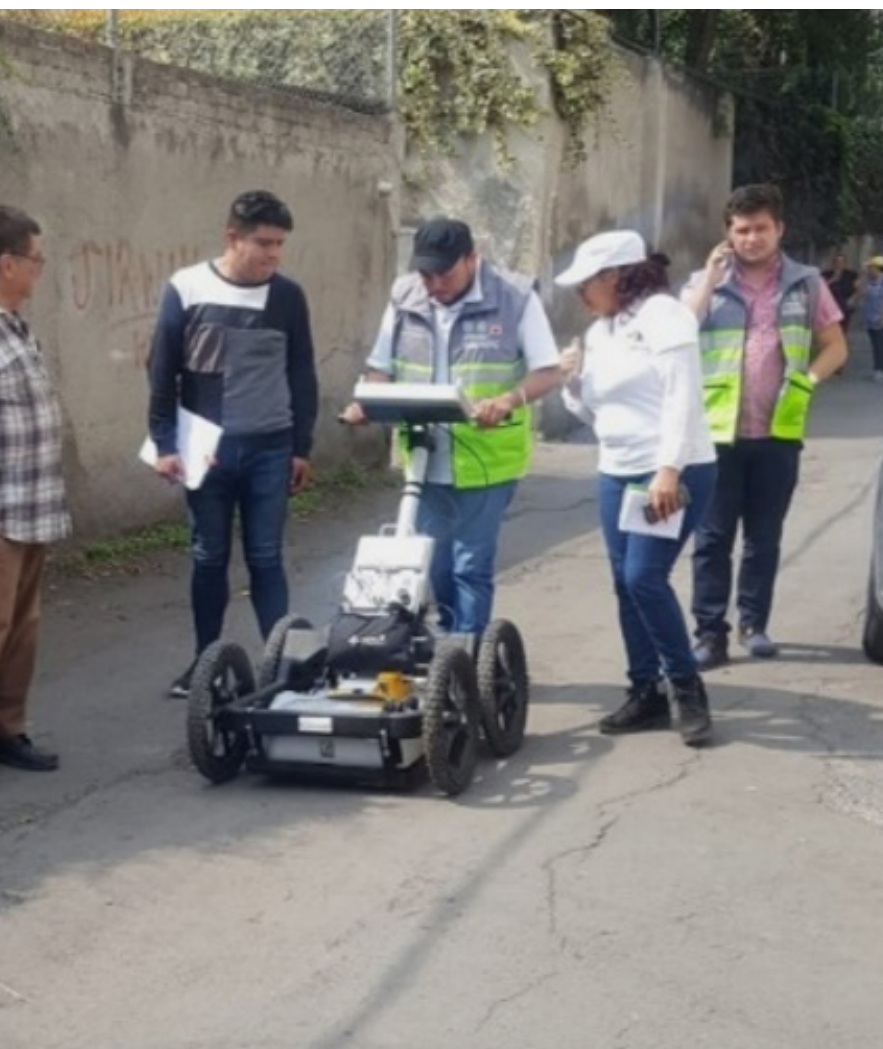
Levantamiento de imágenes con Radar de Penetración Terrestre, actividad que nos ayudará a estructurar la base de datos para la creación del módulo de administración de contenidos de levantamientos en campo, SGIRPC.
